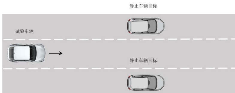
图 11 相邻车道静止车辆目标误响应试验示意图
